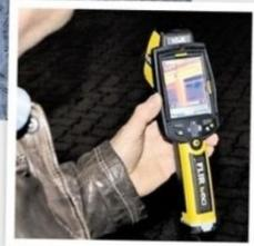
„Schwachstellen zu finden, hilft das kontaktlose Messverfahren. Farbige Aufnahmen machen dabei sofort die Temperaturunterschiede sichtbar. „Damit lassen sich schnell Wärmelecks, wie beispielsweise bei undichten Fenstern, finden“ sagt der Energieberater. Martin Komander folgen, verspricht Komander.
