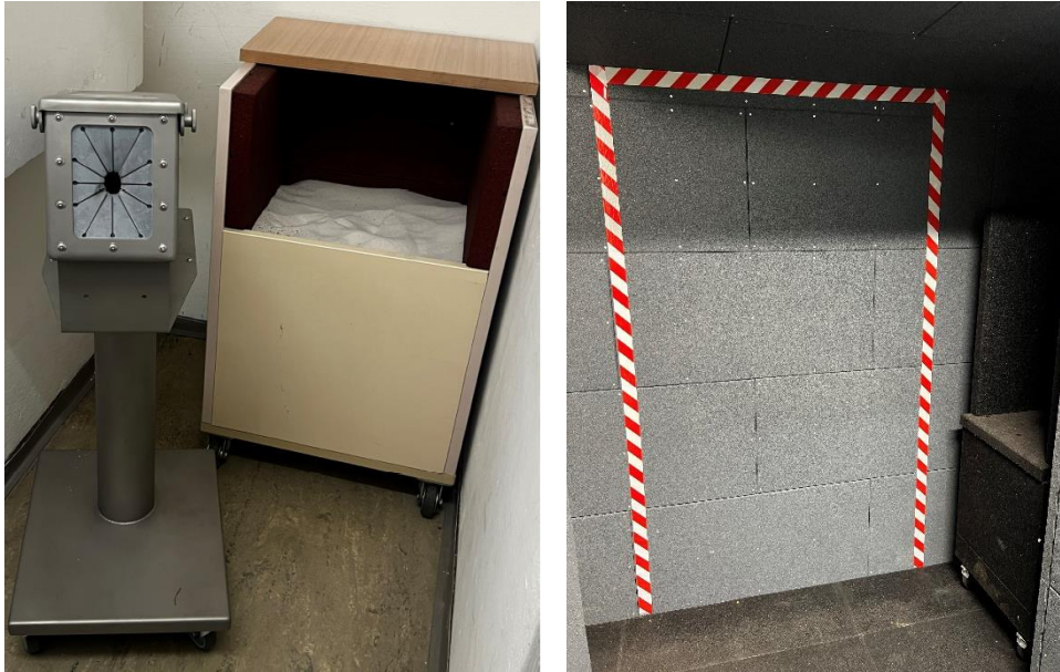
Abbildung 5 – Entladestationen, Sandkugelfang (Altbestand) und Ladeecke. 37
